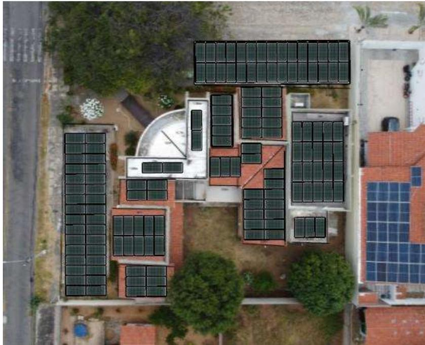
Após as visitas técnicas nos locais de instalação, foi realizado uma simulação 3D para o posicionamento dos módulos e análise de sombreamento das localidades.
