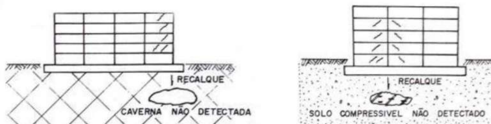
Figura 28 - Deficiência na investigação geotécnica
